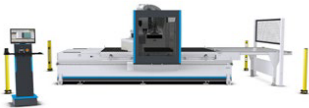
Abb. 3.1.11-02 CNC-Bearbeitungszentrum mit Zugangssicherung durch Lichtschranken
