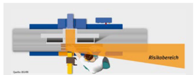
Abb. 3.1.9-02 Risikoaufenthaltsbereich an einer Abrichthobelmaschine
