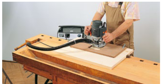
Abb. 3.1.8-06 Handvorschub = Arbeiten mit Handmaschinen
