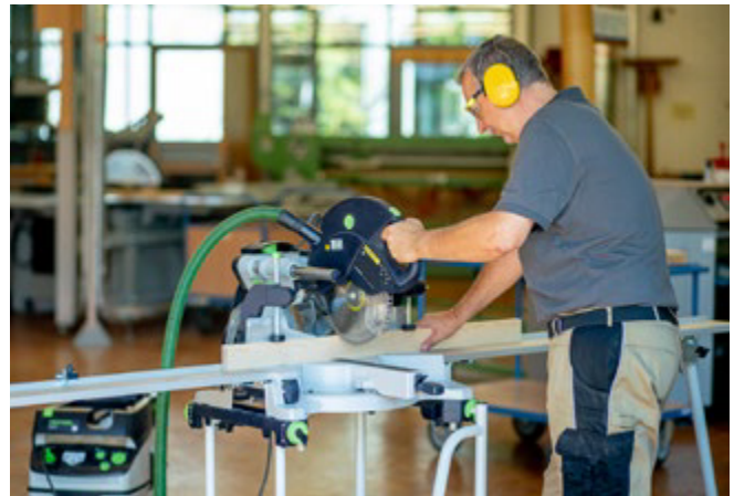
Abb. 3.1.4-02 Mobile Kapp-/Gehrungskreissägemaschine mit zusätzlicher Werkstückauflage
