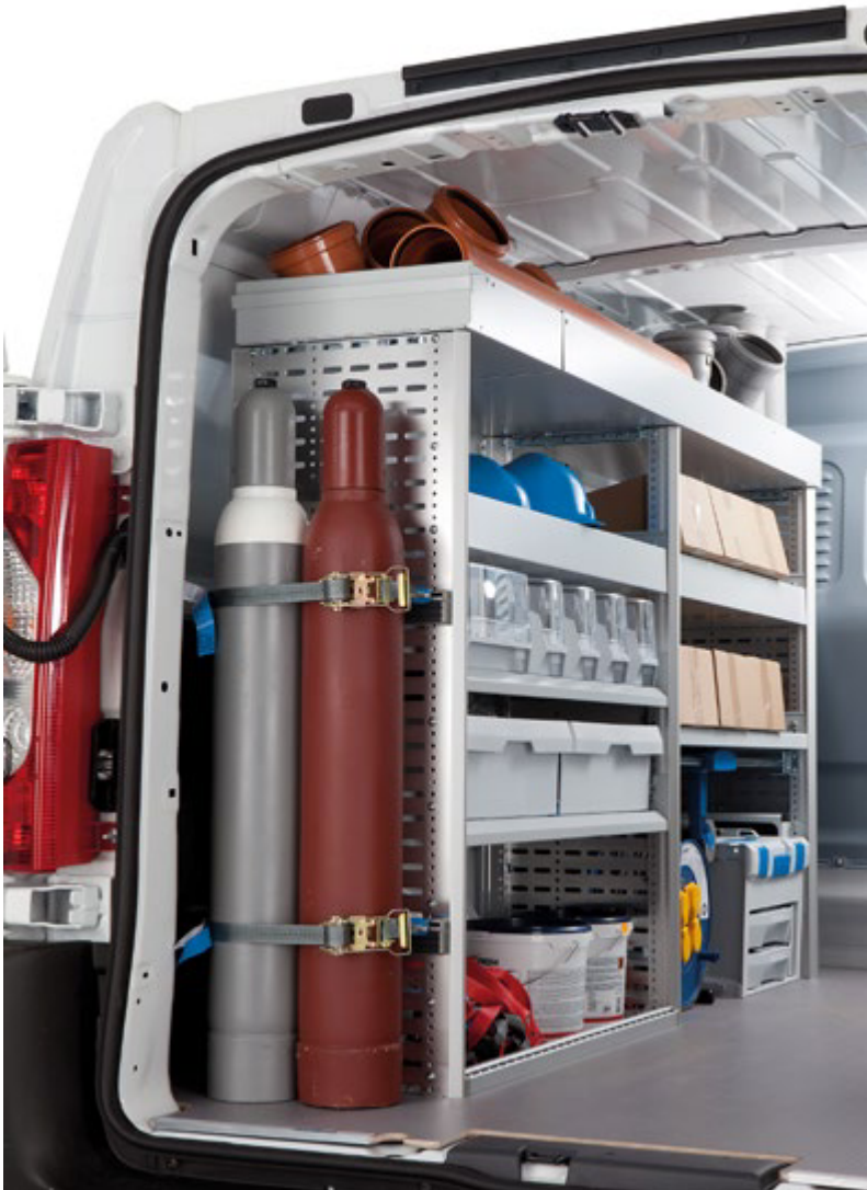
Abb. 3.5.6-01 Fahrzeug mit Einrichtungen zur Ladungssicherung
