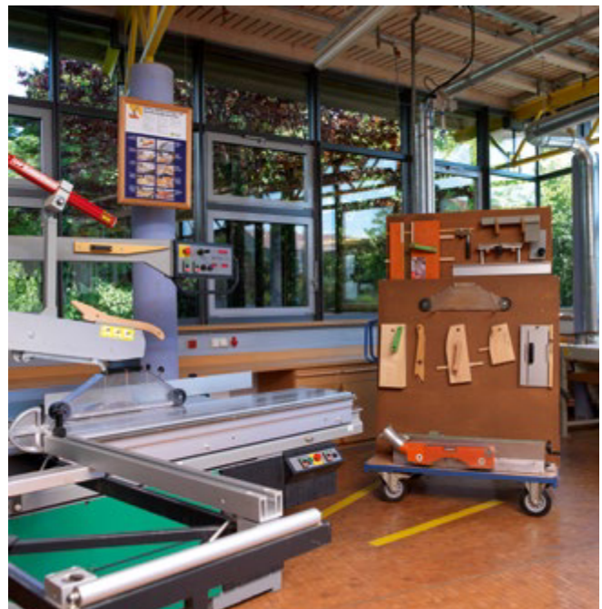
Abb. 2.2.2-04 Formatkreissäge mit zugehörigen Schutzvorrichtungen
