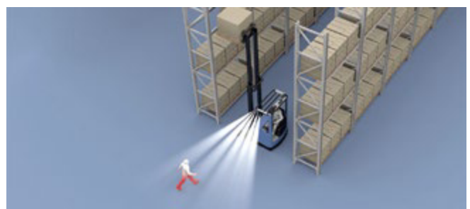
Abb. 3.4.4-04 Personenerkennung in einem Schmalganglager
