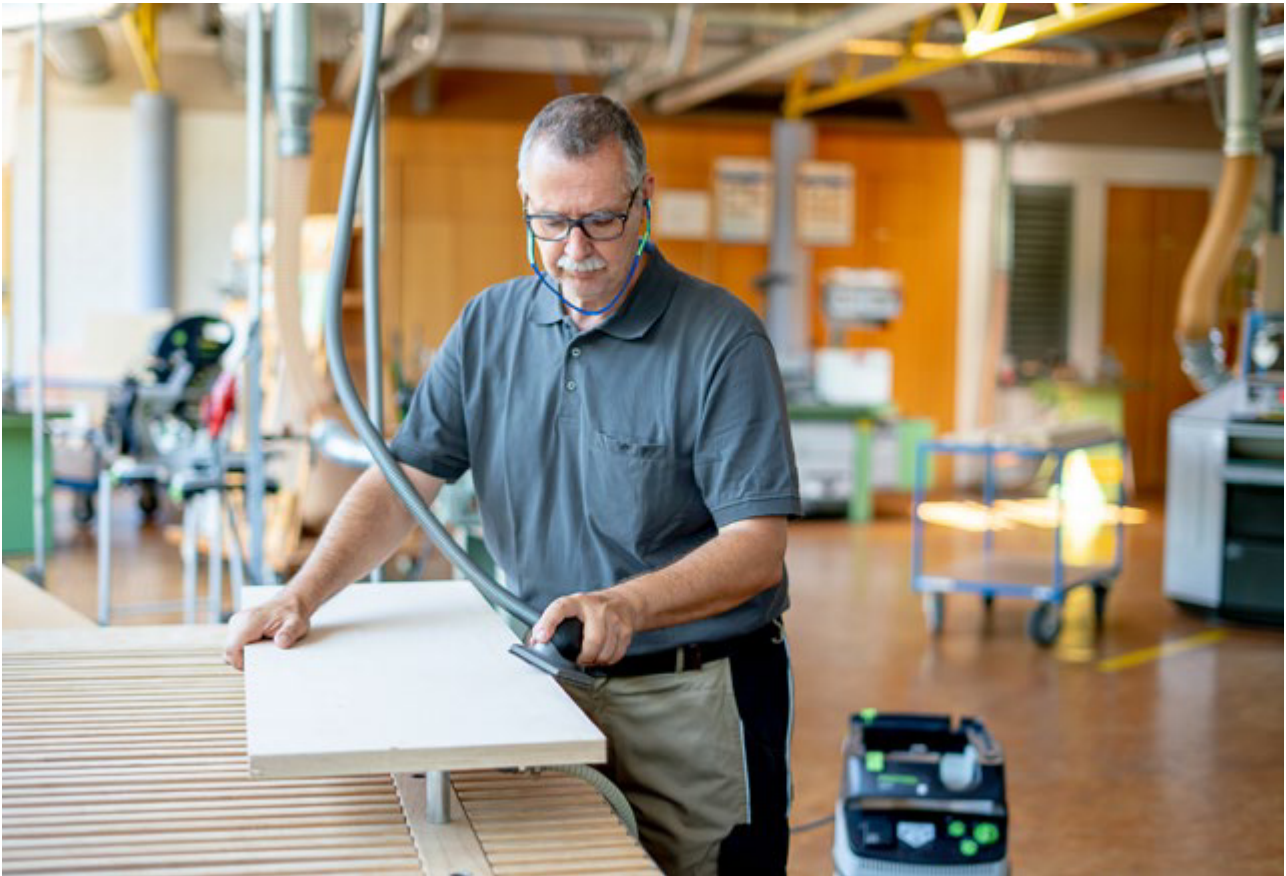
Abb. 3.3.6-01 Handschleifarbeiten mit abgesaugtem Handschleifklotz
