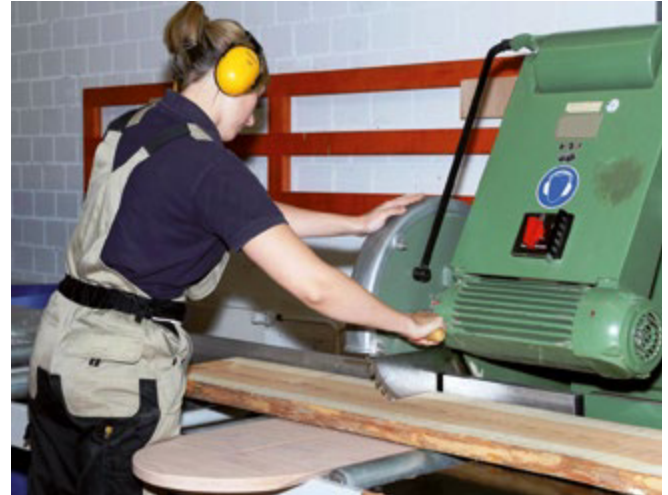
Abb. 3.1.5.06 Handhaltung beim Sägevorgang an einer Pendelkreissägemaschine
