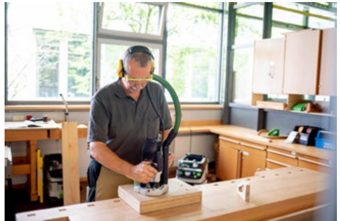
Abb. 3.3.2-02 Maschine an Absaugeinrichtung anschließen
