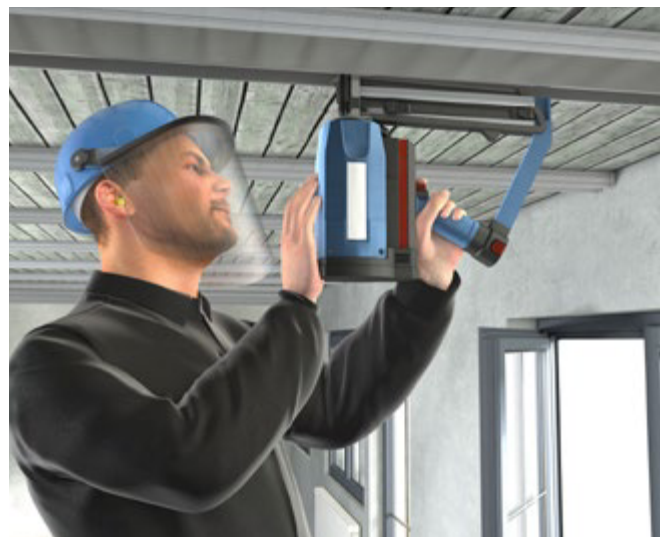
Abb. 3.3.7-03 Eintreibgerät mit Auslösesicherung
