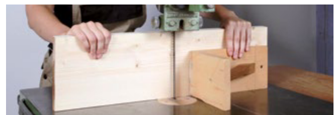
Abb. 3.1.6-08 Quersägen hochkant stehender Werkstücke
