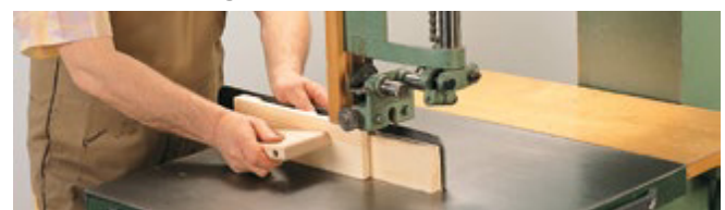
Abb. 3.1.6-10 Sägen kurzer Werkstücke mit Zuführhilfe
