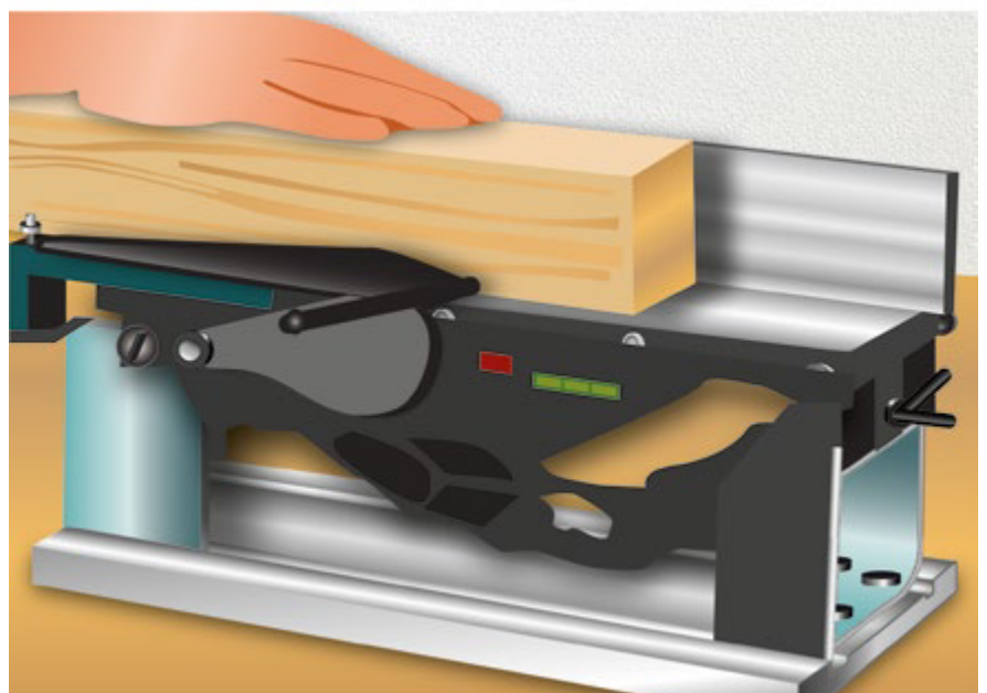
Abb. 3.3.3-02 Elektrohandhobel in stationärer Aufnahme
