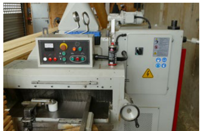
Abb. 3.1.14-04 Einschubbereich mit Splitterfänger
