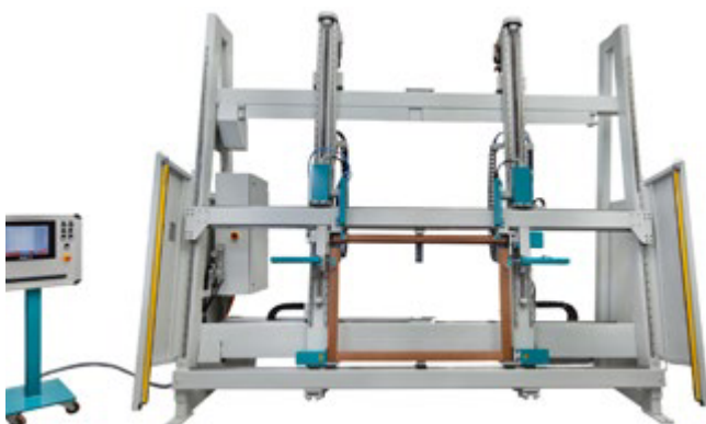
Abb. 3.1.15-04 Rahmenpresse mit Lichtvorhang
