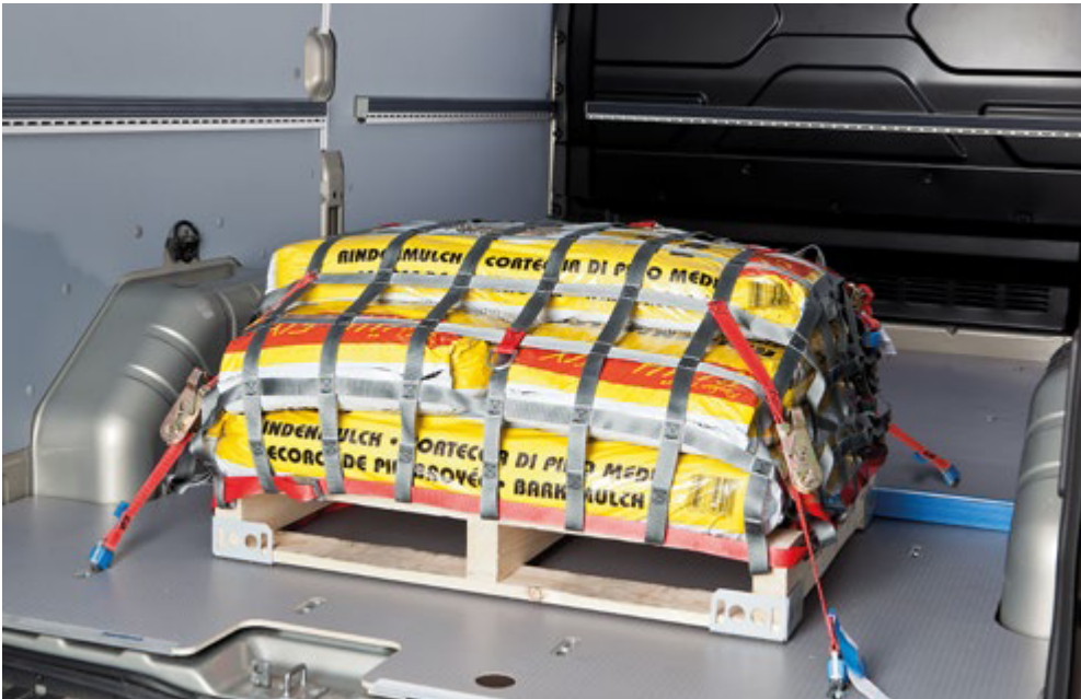
Abb. 3.5.6-02 Niederzurren eines freistehenden Ladungsguts
