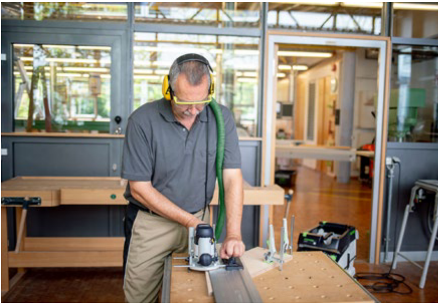
Abb. 3.3.2-03 Einfräsen von Nuten mit einer Führungsschiene
