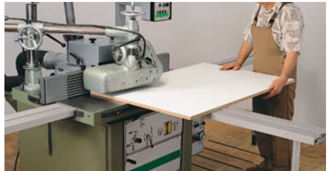
Abb. 3.1.8-04 Handvorschub = Arbeiten mit dem Vorschubapparat
