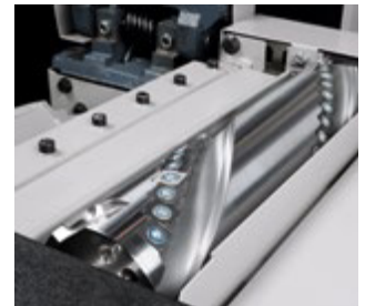
Abb. 3.1.9-08 Spiralhobelmesserwelle mit Einwegwendemessern
