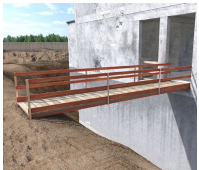
Abb. 3.5.2-03 Laufsteg mit Seitenschutz als Verkehrsweg
