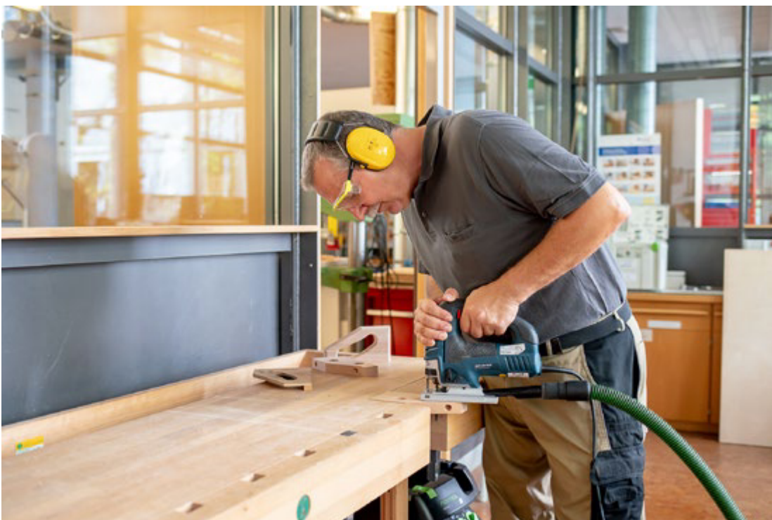
Abb. 3.3.4-02 Werkstücke sicher aufliegen und fixieren
