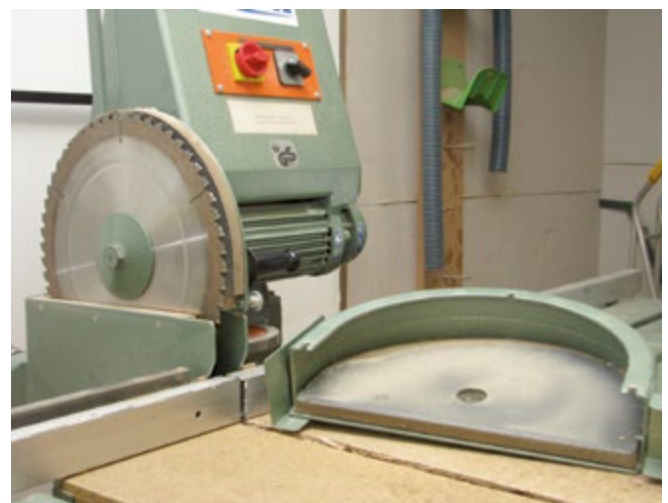
Abb. 3.1.5-07 Auskleidung an Schutzhaube zur Lärmreduzierung
