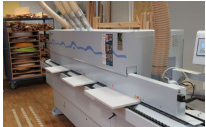
Abb. 3.1.12-04 Kantenanleimmaschine mit Absauganschlüssen
