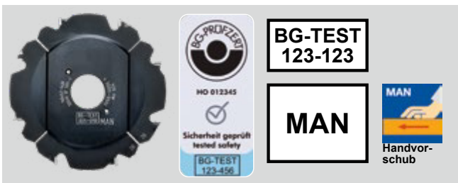
Abb. 3.1.8-03 Kennzeichnung eines Fräswerkzeugs für den Handvorschub
