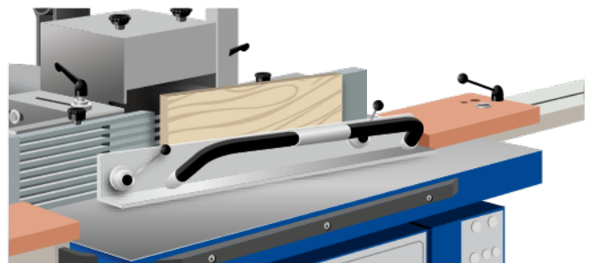
Abb. 3.1.7-06 Spannklammer zum Einsetzfräsen kurzer Werkstücke
