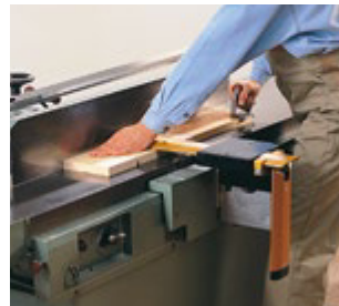
Abb. 3.1.9-07 Schwenkbarer Hilfsanschlag (Abrichten schmaler Leisten)
