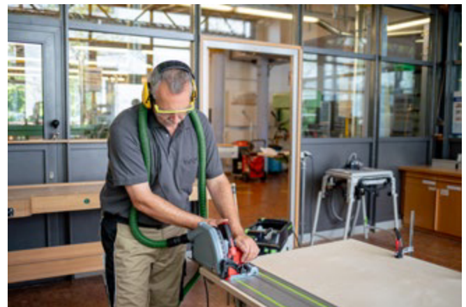
Abb. 3.3.1-11 Sägen mit Führungsschiene
