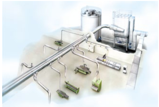
Abb. 2.2.3-02 Komponenten und prinzipieller Aufbau einer Absauganlage
