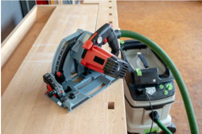
Abb. 3.3.1-09 Handkreissäge mit Absaugung
