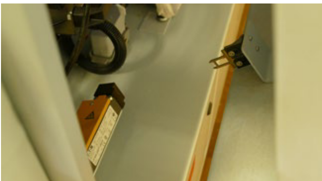
Abb. 3.1.12-03 Elektrisch verriegelte bewegliche Schutzeinrichtung mit Zuhaltfunktion für Kapp- und Bündigfräsaggregate
