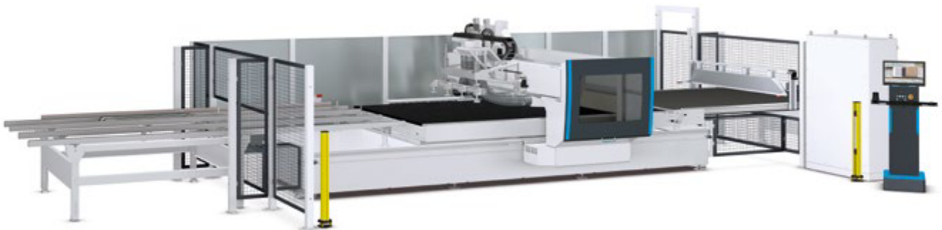
Abb. 3.1.11-01 CNC-Bearbeitungszentrum mit Schutzzaun und Kontakttrittmatte
