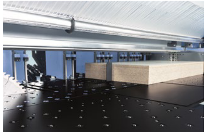
Abb. 3.1.3-02 Hohes Plattenpaket mit Winkelandrückvorrichtung
