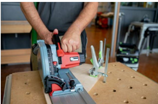
Abb. 3.3.1-10 Sägevorgang mit sicher fixiertem Werkstück
