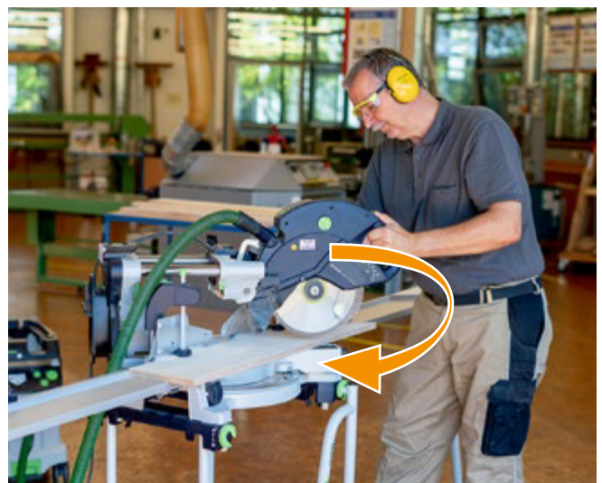
Abb. 3.1.4-05 Sägevorgang beim Einsatz der Zugfunktion
