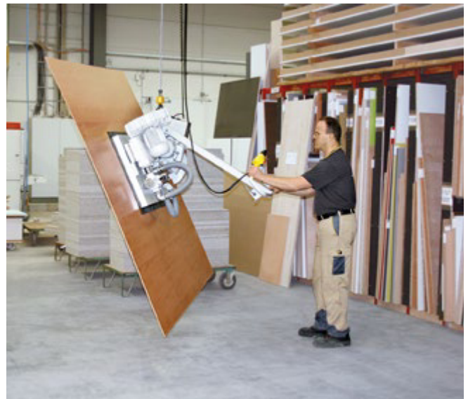
Abb. 3.1.2-08 Vakuum-Hebegerät für das Plattenhandling
