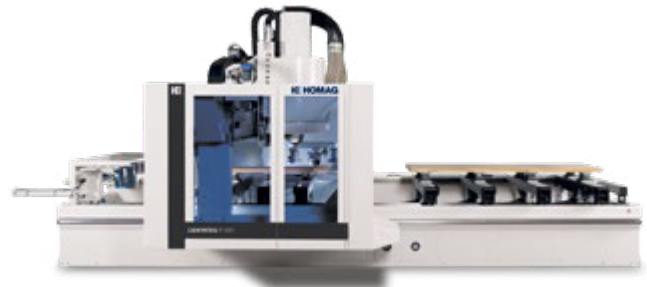
Abb. 3.1.11-04 CNC-Bearbeitungszentrum mit Sicherung durch Bumper
