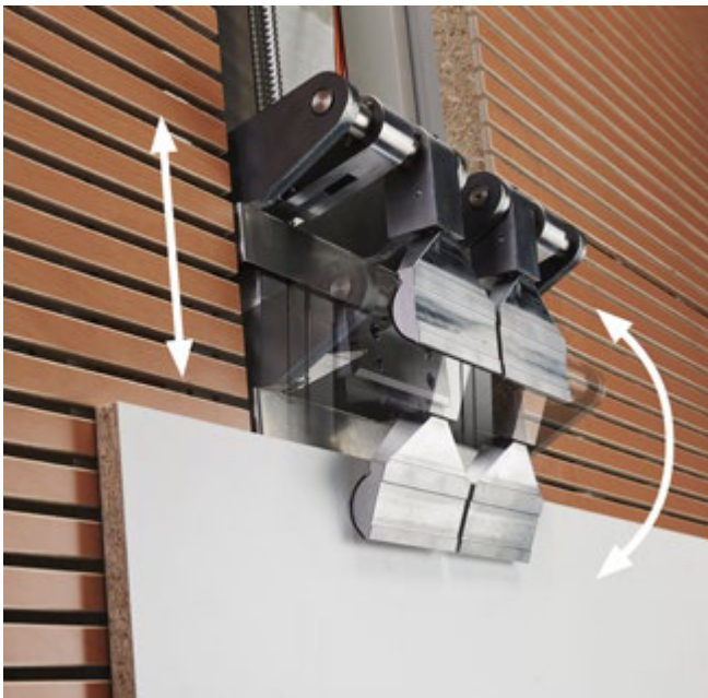
Abb. 3.1.2-04 Klemmvorrichtung für Besäumschnitt
