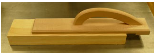
Abb. 3.1.9-05 Zuführlade und Schiebeh Holz für kurze Werkstücke
