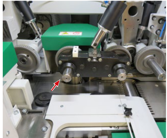
Abb. 3.1.13-05 Verdeckung einer hinteren Vertikalspindel mit Aufsteckspindel
