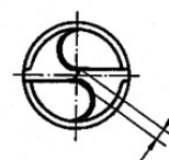
Querschneidenlänge 10% vom Bohrer - Ø
