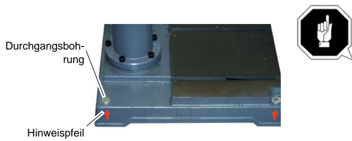
Abb.3-9: Kennzeichnung der Befestigungspunkte an Säulenbohrmaschinen
