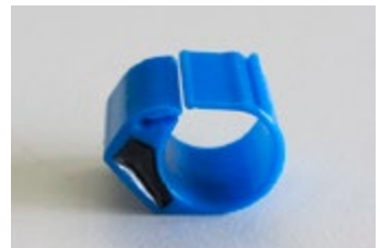
Abb. 3.23 RFID zur Befestigung an der Geräteanschlussleitung
