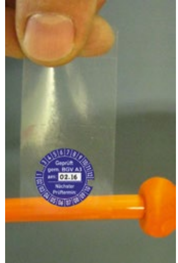
Abb. 3.21 Prüfbänderole zur Befestigung an der Anschlussleitung
