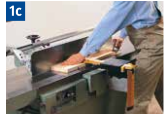
1c Abrichten kurzer Werkstücke mit Schutzbrücke und Schiebehholz
