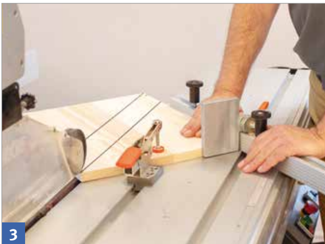
Spannen eines Werkstücks zum Winkelsägen
