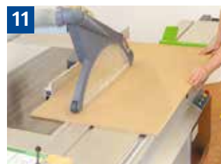
Schutzeinrichtungen und Handhaltung beim Einsetzsägen. Sägeblatt wird von unten nach oben durch das Werkstück angehoben.
