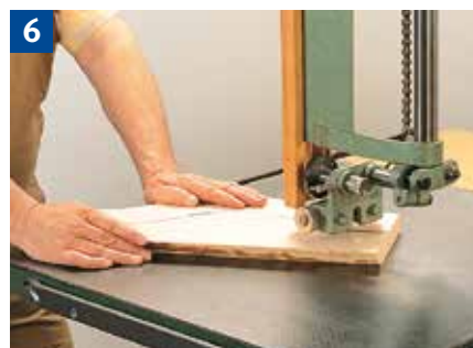
Handhaltung beim Herstellen geschweiften Werkstücke
