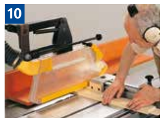
Schutzeinrichtung und Handhaltung beim Absetzen von Zapfen
