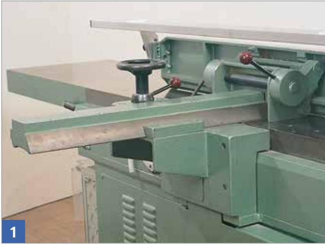
Anschlagführung ist gleichzeitig Messerwellenverdeckung.
