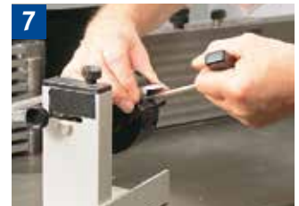
Lösen der Spannschrauben mit vorgegebenem Werkzeug (Imbusschlüssel)
