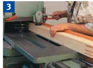
Handvorschub = Arbeiten mit dem Schiebeschlitten
