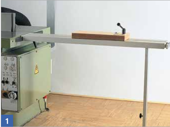
Tischverlängerung mit verstellbarem Queranschlag
