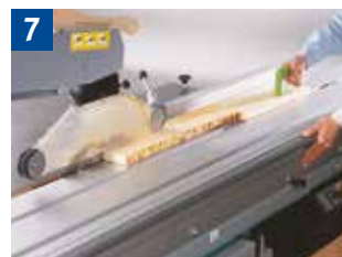
Sägen von Leisten mit Schiebehholz
