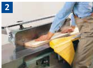
2 Abrichten breiter Werkstücke mit Gliederschwingschutz
