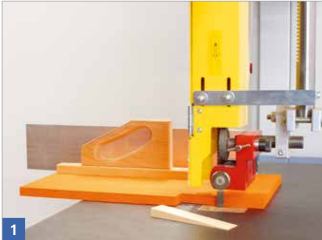
1 Zum Sägen von Keilen eine Keilschneidlade verwenden.
