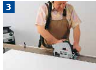
3 Einsetzsägen mit Tauchkreissäge und Führungsschiene mit Anschlagnocken (als Rückschlagsicherung)
