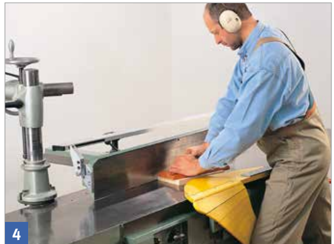
Zuführlade auf das Werkstück auflegen.
