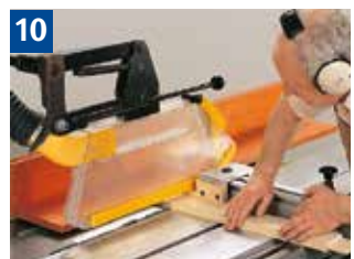
Schutzeinrichtung und Handhaltung beim Absetzen von Zapfen
