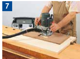
7 Einsatz der Handoberfräsmaschine mit Schablone
