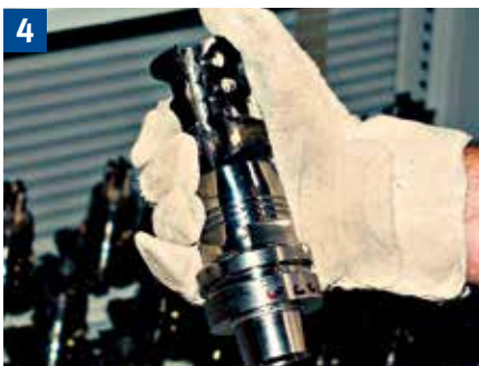
Beim Ein- und Ausbauen von Werkzeugen mit Hartmetallwechselschneiden die Hände mit Handschuhen oder einem Lappen schützen.
