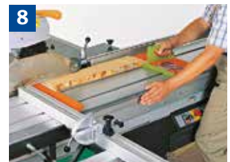
Sägen von Leisten mit vorderer und hinterer Sägehilfe
