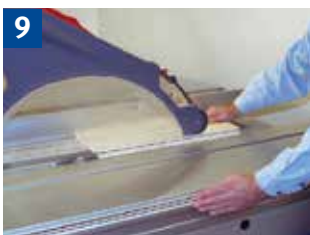
Schutzeinrichtung und Handhaltung beim Fälen
