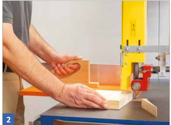
2 Für die Führung der Keilschneidlade den Parallelanschlag auf den gewünschten Abstand zum Bandsägeblatt einrichten.
