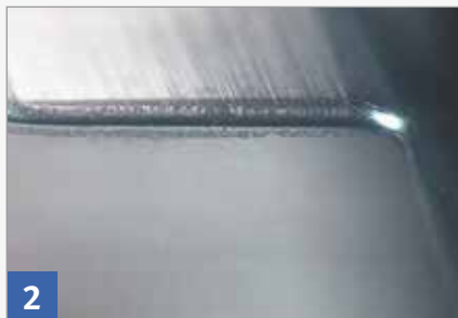
Physikalischer Verschleiß bei einer Stahlschneide
