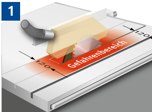
Eingreifen in den Gefahrenbereich nur mit Hilfsmittel
