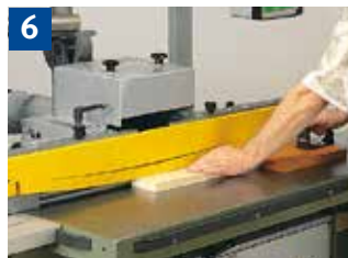
6 Fräsen von kleinen Werkstücken am Anschlag mit Bogenfeder und Schiebeholz
