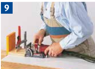
9 Einfräsen von Nuten, kleine Werkstücke festspannen.
