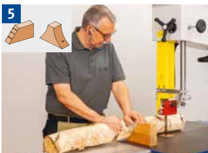
Quersägen von Rundholz mit Keilstütze
