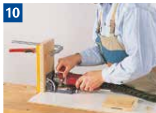
10 Einfräsen von Nuten mit Stützwinkel
