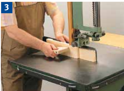
Auftrennen am Anschlag mit Zuführlade
