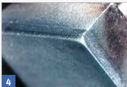
Thermischer Verschleiß bei einer Hartmetallschneide durch zu hohe Schnittgeschwindigkeiten
