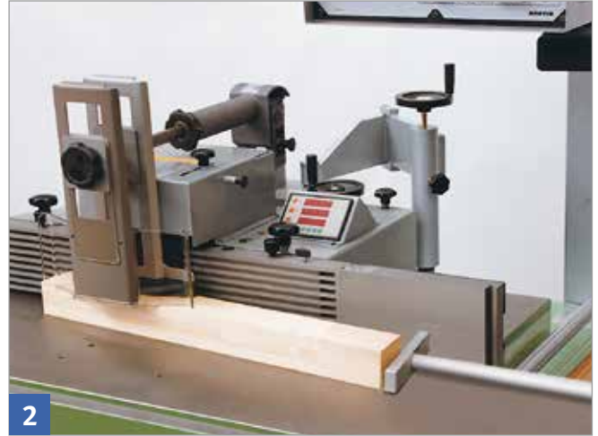
Rückschlagsicherung für Tischfräsmaschinen mit überlangem Tisch
