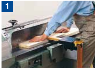
1 Abrichten breiter Werkstücke mit Schutzbrücke
