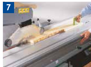
Sägen von Leisten mit Schiebehholz
