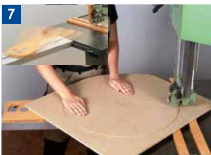
Vorrichtung und Handhaltung beim Herstellen kreisförmiger Werkstücke
