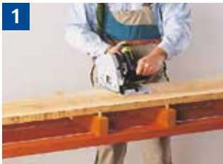
1 Sägen von Massivholz auf Unterlagen mit Anschlagknoppen
