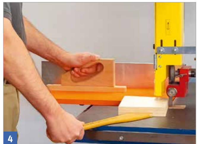
4 Bei Abständen von weniger als 120 mm zum Sägeblatt Schiebstock zum Andrücken benutzen.
