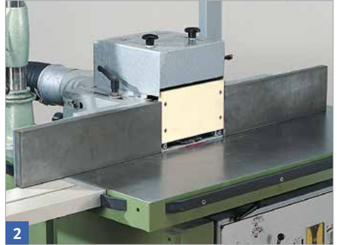
2 In die Anschlaghälften einsetzbare Anschlagbrücken
