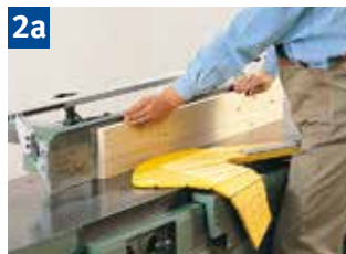
2a Fügen breiter Werkstücke mit Gliederschwingschutz
