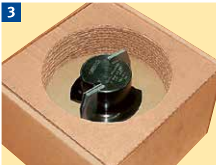
Werkzeuge mit Hartmetallwechselschneiden immer in der Originalverpackung transportieren.
