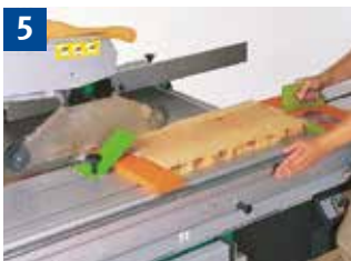
Vorrichtung und Handhaltung beim Besäumen
