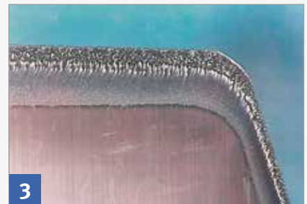
Chemischer Verschleiß bei einer Hartmetallschneide durch Holzinhaltsstoffe
