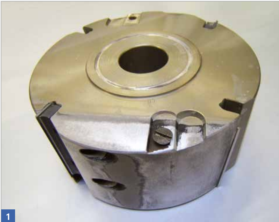
Durch Kaliumhydroxid angegriffenes Aluminiumwerkzeug
