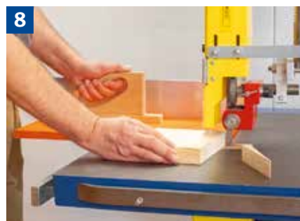
Sägen von Keilen mit Keilschneidlade
