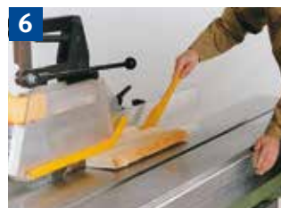
Sägen schmaler Werkstücke mit Schiebstock
