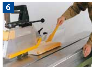
Sägen schmaler Werkstücke mit Schiebstock
