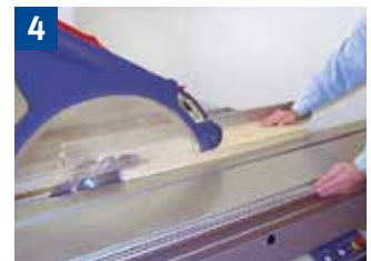
Längssägen von Breite mit der Hand (Breite über 120 mm)
