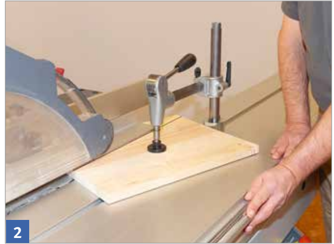
Spannen eines Werkstücks ohne Anschlag
