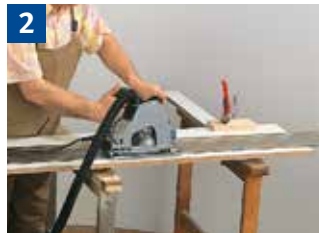
2 Sägen von Plattenmaterial mit Führungsschiene
