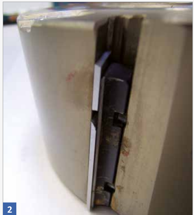
Durch Überlastung des Werkzeugs gebrochene Hartmetallschneide
