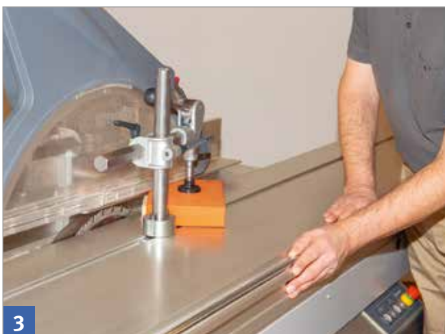
Schablonensägen mit Spannvorrichtung
