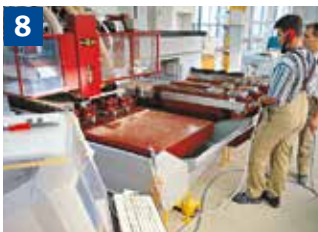
Mechanischer Vorschub = z. B. Arbeiten mit CNC-Bearbeitungszentrum
