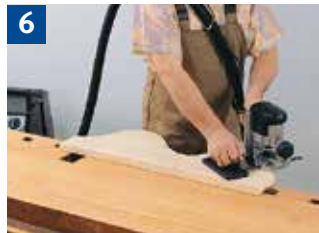
6 Bearbeiten von Werkstückkanten mit der Handoberfräsmaschine
