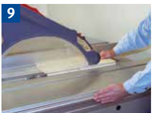
Schutzeinrichtung und Handhaltung beim Fälen
