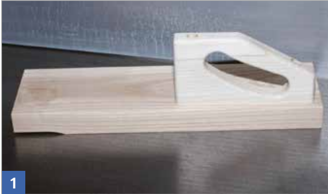
Beim Abrichten kurzer Werkstücke ein Schiebeh Holz (Bild 1)
