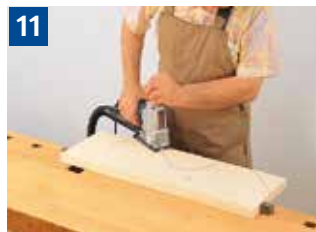
11 Sägen geschweißter Werkstücke
