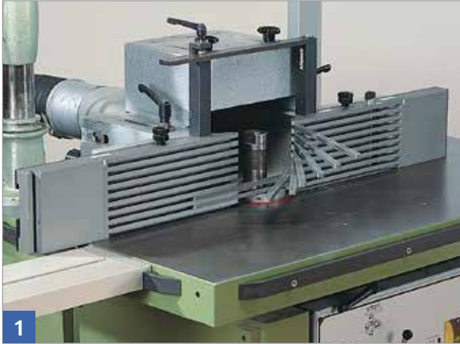
1 Anschlag mit schwenkbaren Überbrückungsstegen
