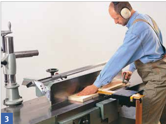
Schutzbrücke auf Werkstückdicke einstellen.
