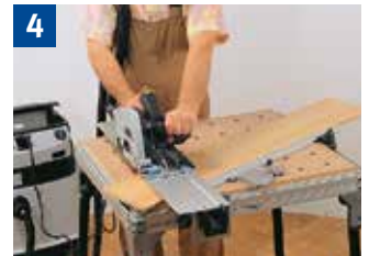
4 Bei Montageschnitten für sichere Werkstückauflage und präzise Werkzeugführung sorgen.
