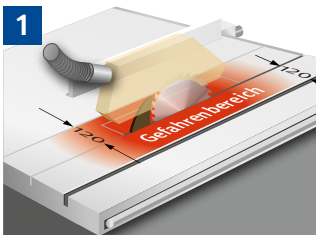
Eingreifen in den Gefahrenbereich nur mit Hilfsmittel
