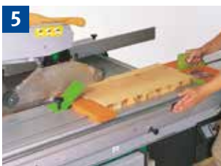
Vorrichtung und Handhaltung beim Besäumen
