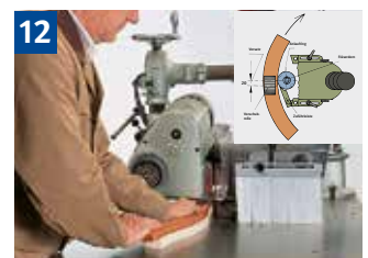
12 Fräsen von geschweiften Werkstücken mit Anlaufring, Bogenfräshaube und Vorschubapparat (nur 1 Rolle)
