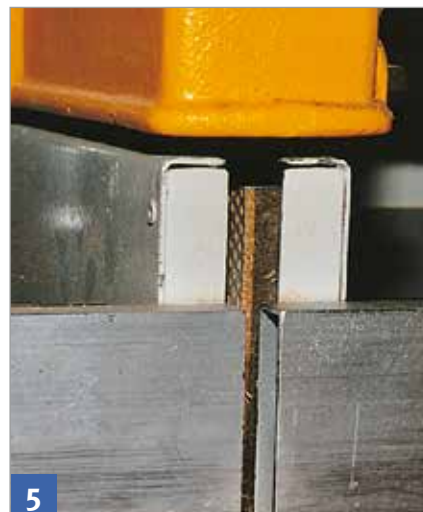
Schmaler Schlitz für Sägeblattdurchtritt
