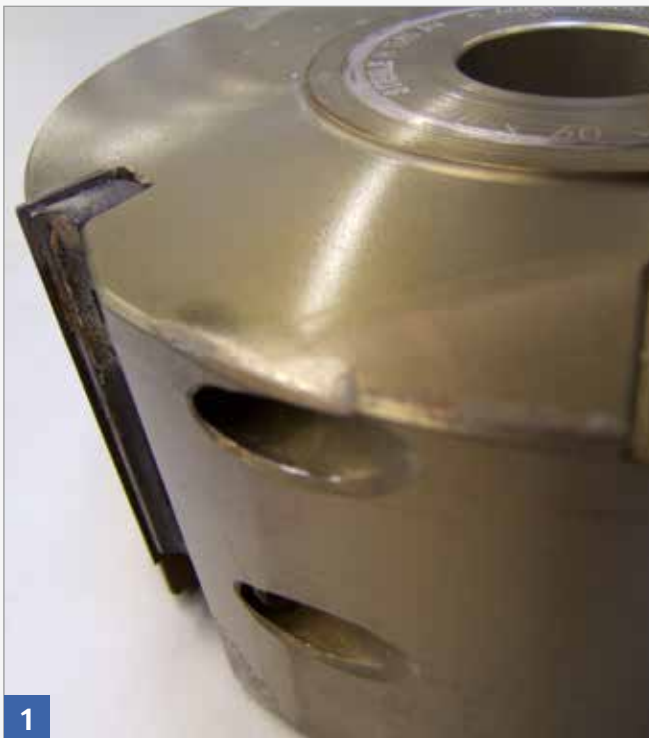
Durch Werkzeugsturz deformierter Aluminiumtragkörper
