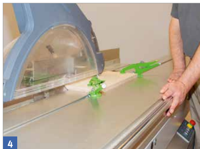
Schablonensägen mit Spannvorrichtung
