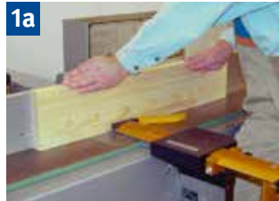
1a Fügen breiter Werkstücke mit Schutzbrücke
