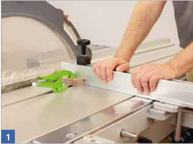
Spannen eines kleinen Werkstücks vor dem Queranschlag
