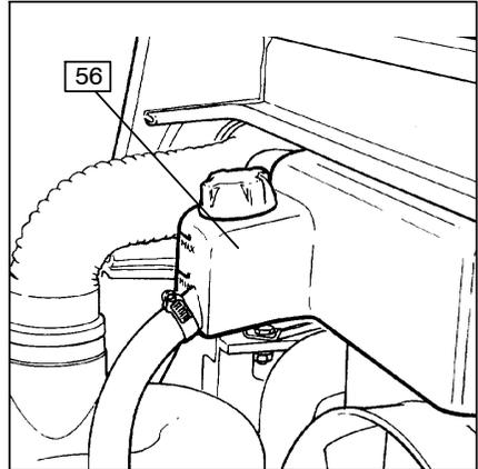
Fügen Sie beim Auffüllen eine vorgemischte Lösung aus Wasser und Frostschutzmittel im gleichen Verhältnis zu der bereits im System vorhandenen.
