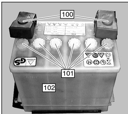
Die Säuredichte bei einer ausreichend geladenen Batterie beträgt 1,24 bis 1,28 kg/l.
