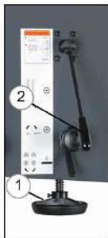
Abb. 12: Einstellen der Bandspannung
