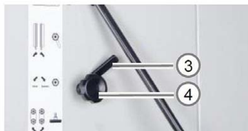
Abb. 13: Einstellen des Sägebandlaufs
