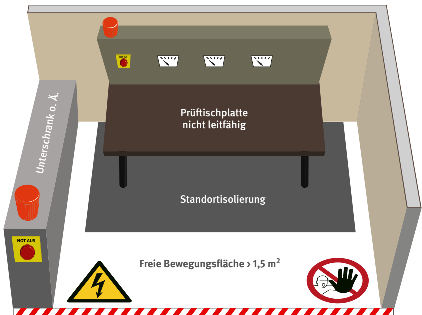
Abb. 6.1 Beispiel für einen Prüfplatz in einer Elektrowerkstatt.
