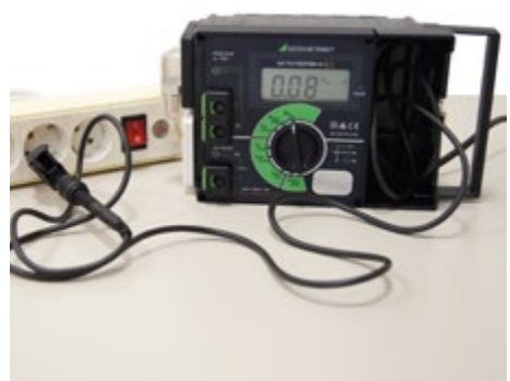
Abb. 5.9 Prüfgerät mit manuellem Prüfablauf. Zusätzliche Eigenschaften: Separate Steckdosen für jeweils Prüf- bzw. Netzspannung zur Durchführung von Strommessungen nach dem Ersatzableitstrom- bzw. Differenzstromverfahren sowie zur Funktionsprüfung an Netzspannung
