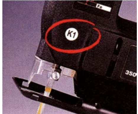
Abb. 8.1 Kennzeichnung der Anwendungskategorie am Betriebsmittel, hier K 1
