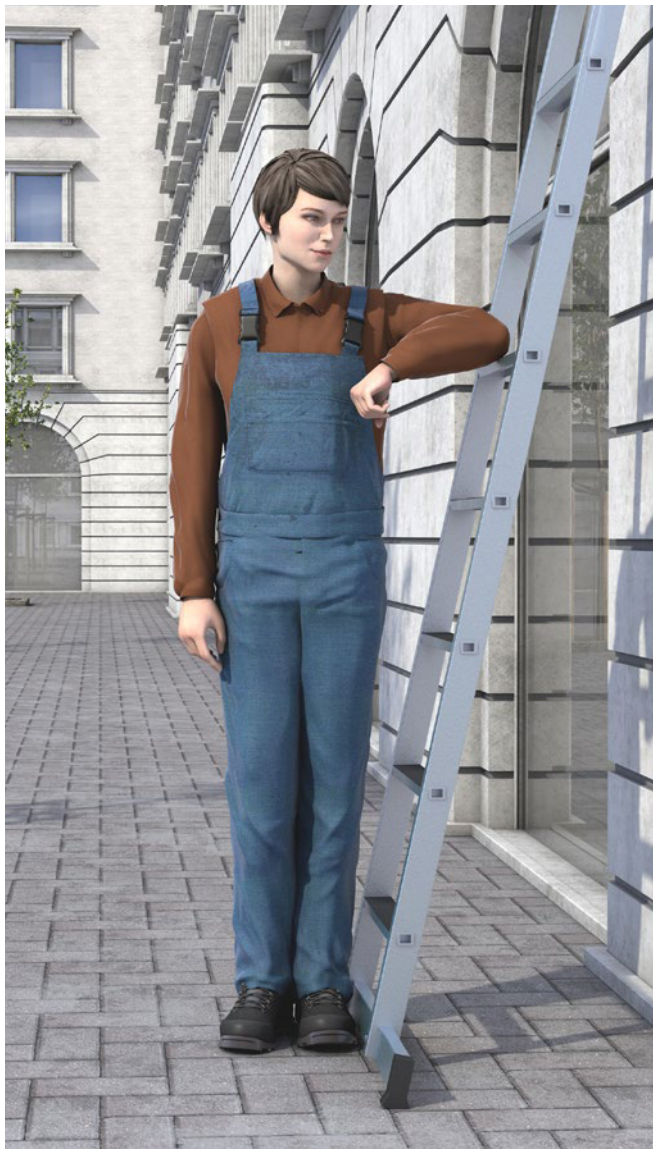
Abb. 50 Anstellwinkel der Glasreinigerleiter
