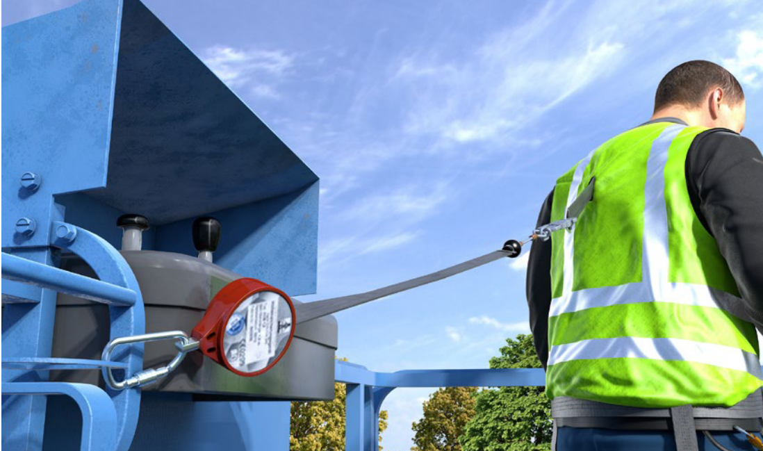
Abb. 43 Einsatz von PSA gegen Absturz in der Hubarbeits- bühne mit zugelassenem Anschlagpunkt
