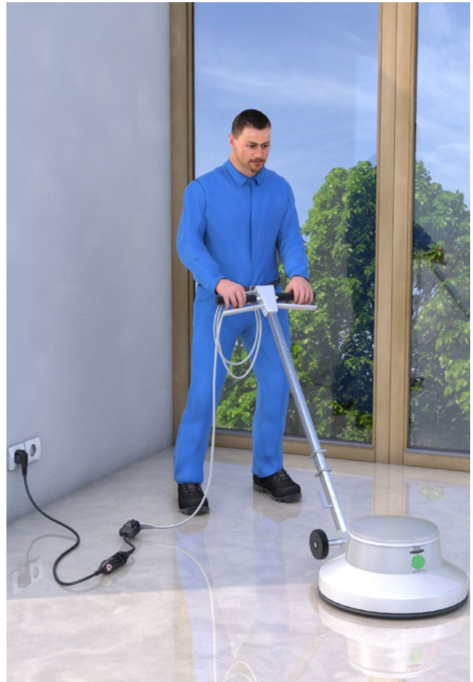
Abb. 70 Einscheibenmaschine mit PRCD-S
