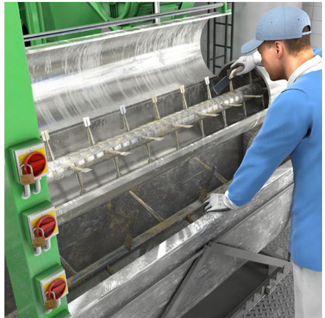
Abb. 73 Anlage gegen Einschalten gesichert
