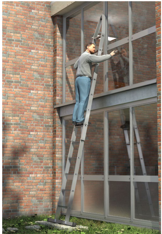
Abb. 46 Glasreinigerleiter mit Fußverbreiterung auf tragfähigen Untergrund
