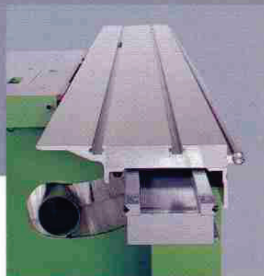
Alu. elox. Besäumwagen mit gehärteten Stahlführungsbahnen und Kugelschlitten
