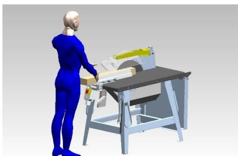
Das Werkstück wird entlang des Anschlages nach vorne geführt. Für die letzten 120mm ist der Schiebestock zu verwenden; desgleichen wenn der Abstand zwischen Sägeblatt und Anschlag weniger als 120 mm beträgt. Beim Auf trennen muss der Anschlag so in seiner Längsrichtung verschoben werden, dass sein Ende auf Höhe der Sägeblattmitte liegt.
