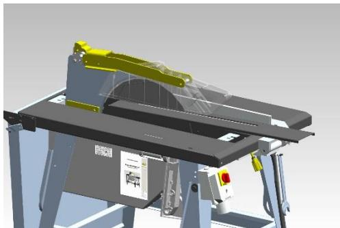
2. Mutter SW 30 (Linksgewinde) mit Gegenhalter und Maulschlüssel abschrauben
