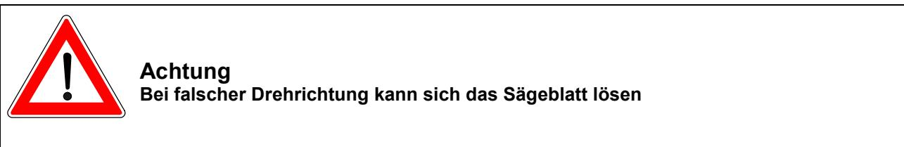
Wenn beim Anschluss der Maschine der Motor falsch herum läuft, muss die Änderung der Drehrichtung nur durch das Umpolen an der Zuleitung herbeigeführt werden.(Phasenwender)
